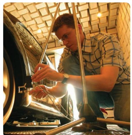
Markus Fugel vom Institut für Fahrzeugtechnik an der TU Braunschweig misst die Schallintensität am drehenden Reifen eines VW Beetle. Dabei ermittelt er den Ursprung von Geräuschen und das akustische Abstrahlverhalten von Fahrzeugkomponenten.
